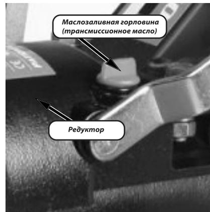
Каждый раз перед началом культивации проверяйте состояние редуктора, вала редуктора, фрез и креплений. При наличии масляных пятен в нижней части редуктора или вале обратитесь в сервисный центр. Если фрезы пришли в негодность, приобретите новые. Помните, что мотоблок поставляется без масла в редукторе.
