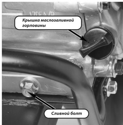
Открутите болт сливного отверстия и крышку маслозаливной горловины. Слейте отработанное масло. Произведите замену моторного масла первый раз после 5 моточасов работы. Периодичность замены моторного масла во время эксплуатации мотоблока - каждые 50 моточасов работы или 1 раз в сезон.
