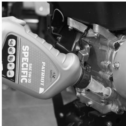
Закрутите болт сливного отверстия. Залейте новое масло до уровня, указанного на щупе. При эксплуатации культиватора при сильной нагрузке или при повышенной температуре окружающего воздуха масло следует заменять каждые 25 моточасов. Помните, что мотоблок поставляется без моторного масла в двигателе.
