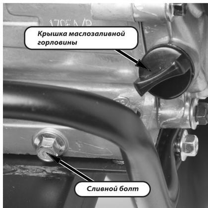
Открутите болт сливного отверстия и крышку маслосливной горловины. Слейте отработанное масло. Производите замену моторного масла первый раз после 5 моточасов работы. Периодичность замены моторного масла во время эксплуатации мотоблока - каждые 50 моточасов работы или 1 раз в сезон.
