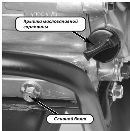
Открутите болт сливного отверстия и крышку маслосливной горловины. Слейте отработанное масло. Произведите замену моторного масла первый раз после 5 моточасов работы. Периодичность замены моторного масла во время эксплуатации мотоблока - каждые 50 моточасов работы или 1 раз в сезон.
