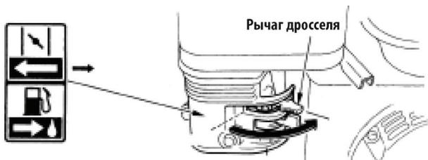
1. Передвигайте рычаг дросселя постепенно во время прогрева двигателя до открытого положения (OPEN).
