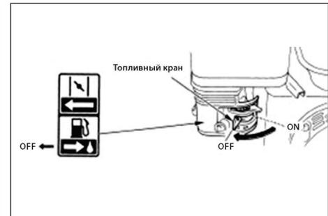
Поверните топливный кран до положения OFF.
