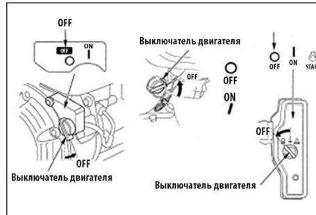
Поверните выключатель двигателя до положения OFF.
