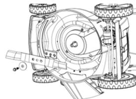
5. Затяните болт моментом затяжки 45-55 Н-м. Проверьте надежность соединения. После установки ножа, запустите двигатель, дайте ему поработать 1-2 минуты без нагрузки для проверки правильности установки. При возникновении повышенной вибрации немедленно остановите устройство и обратитесь в авторизованный сервисный центр.
