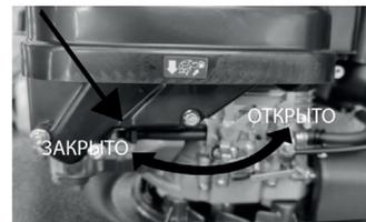
4. При запуске холодного двигателя переведите рычаг управления дроссельной и воздушной заслонками вперёд в положение «ЗАКРЫТО». При запуске тёплого двигателя рекомендуется установить рычаг в положение «БЫСТРО».
