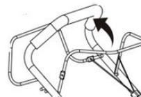
6. Вытяните ручку стартера примерно на 10-15 см. Пока вы не почувствуете сопротивление, а затем запустите двигатель резким рывком.
