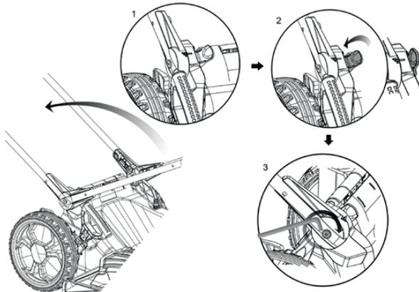
Выберите удобную установку высоты рукоятки и зафиксируйте нижние быстрозажимные фиксаторы.
